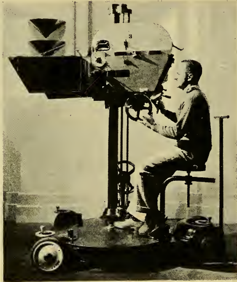
FIG. 29.—Camera dolly (rotambulator).
